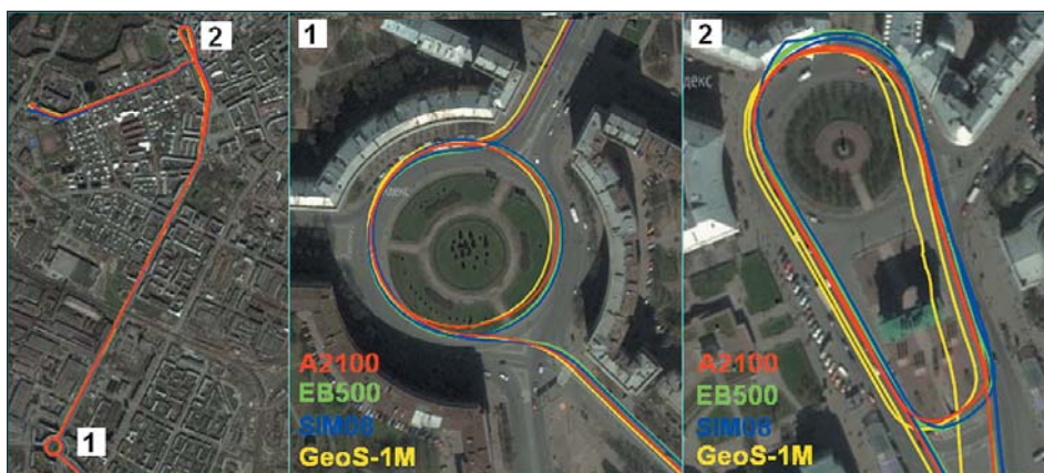
Рис. 2. Треки при движении автомобиля по городу (различные чипсеты)
