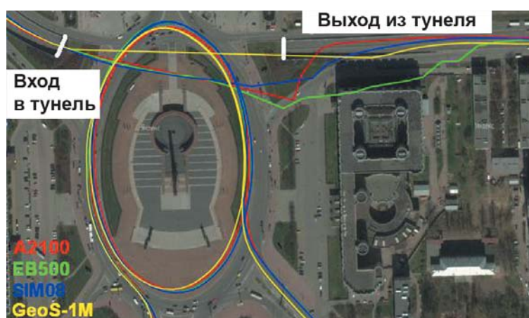
Рис. 3. Треки при прохождении автомобиля через туннель (различные чипсеты)
