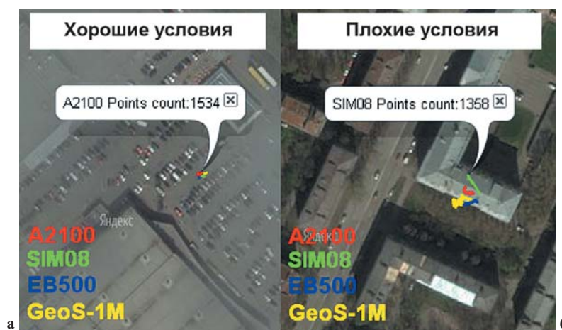
Рис. 1. Треки во время стоянки автомобиля (различные чипсеты): а) в открытом поле; б) во дворе многоэтажного дома под густыми кронами деревьев
